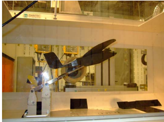
(d) Mounted in the wind tunnel.
